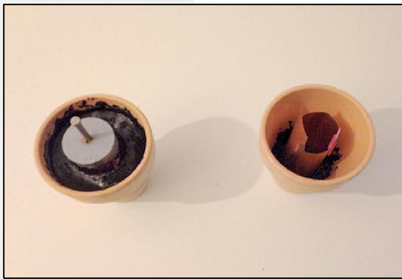
Abb. 2: Die nachgebaute Parther-Batterie
