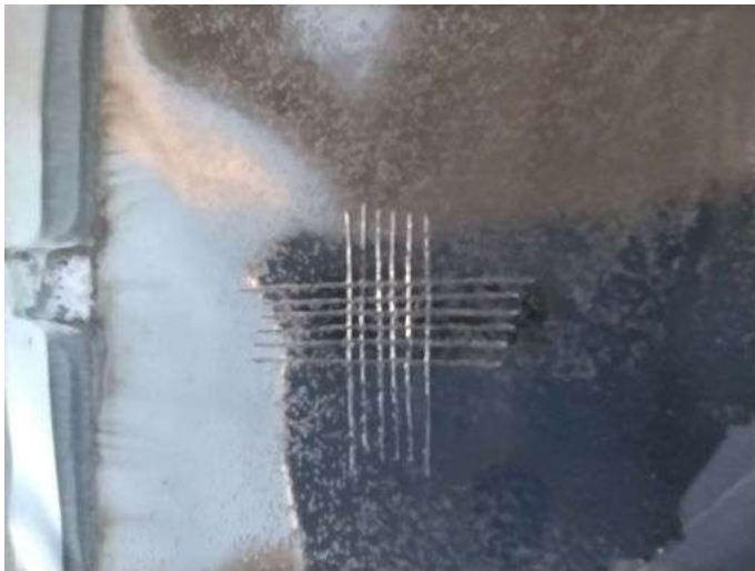
Abbildung 10: Gitterschnittprüfung einer haftfesten Nickelschicht auf Al-Folie
