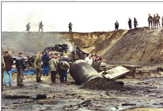
Abb. 1: Nach der Explosion: Der CASTOR ist aus seiner Position geschleudert worden., Quelle: BAM [5]
