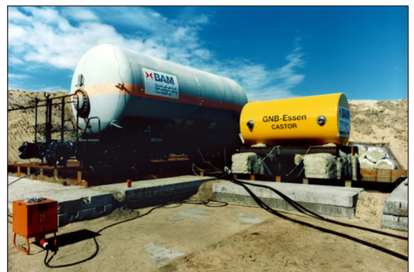
Abb. 1: Versuchsaufbau: CASTOR-Behälter steht neben dem Kesselwagen, Quelle: BAM [5]
