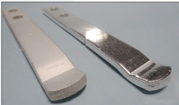
Abb. 1: Silber-Graphit beschichtetes Bauteil vor (links) und nach (rechts) dem Kugelpolieren ( https://www.pieper-oberflaechentechnik.de/leistungen/verfahren/silbergraphitagc.html )
